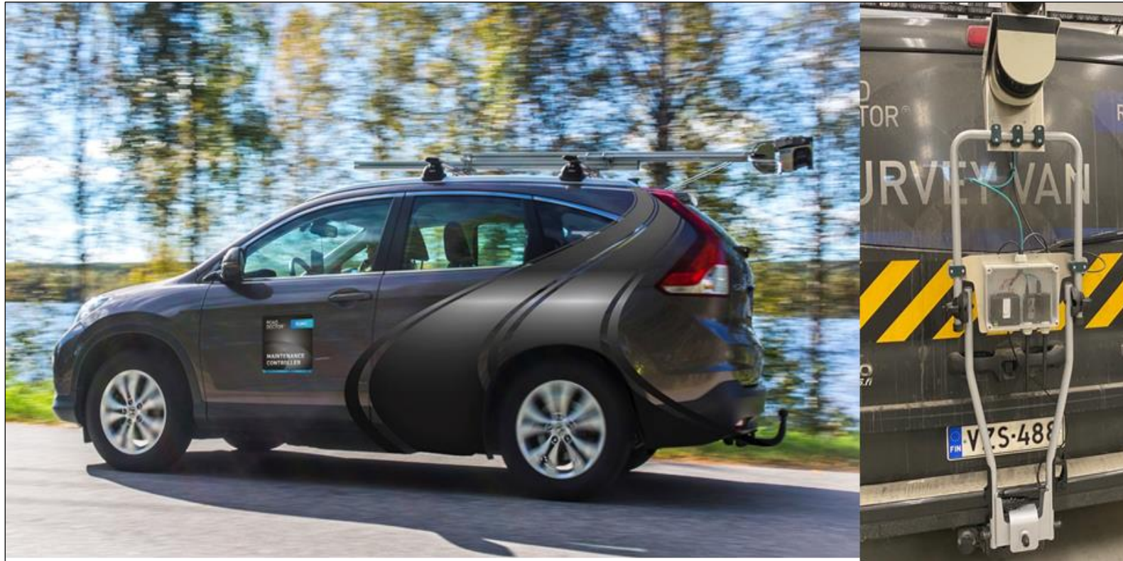
Laserový skener je možno instalovat na střechu či tažné zařízení
