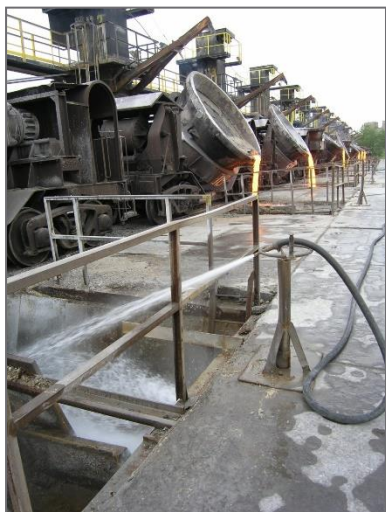
Granulovaná vysokopeční struska z Liberty Ostrava
