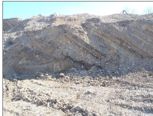
Skrývka v lomu Kotouč ve Štramberku na 6.etáži – střídání poloh vápenců a doprovodných hornin (použita do násypů na D48 Rybí – MÚK Rychaltice, 2019)
